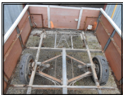
Le fond en mauvais état est enlevé
